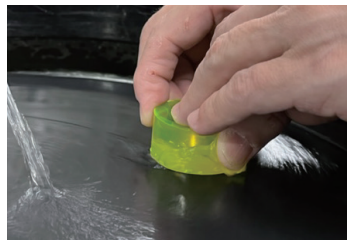
写真7 任意の箇所まで研磨し、断面を出す。
