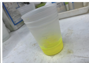
写真4 均一に混ぜて蛍光包埋樹脂を作製
