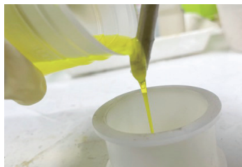
写真5 模擬試料をカップ内に静置し、蛍光包埋樹脂を流し込んで包埋・硬化させる。
