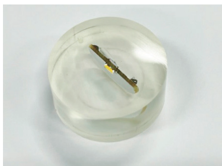
写真11 樹脂包埋、研磨してLEDの断面を露出させる。(蛍光物質を用いた包埋は行わない)
