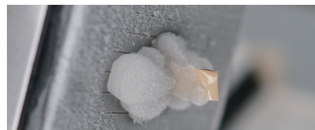
② 試料を -30℃に冷やして、氷包埋する。氷包埋は、文字通り氷で試料を包埋する方法であり、試料を水滴で覆って冷却し、氷らせて固定する。氷包埋は、有姿のまま固定・切断が困難な柔らかい試料に適用する。
