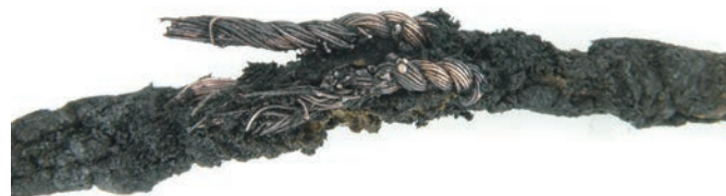
図4 出火原因となったコードの接続部 (事例の物ではない)
