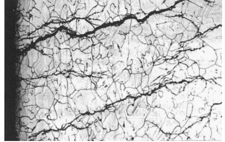
図 14 SUS304 の応力腐食割れ ※塩化マグネシウム溶液の応力腐食割れ試験による
