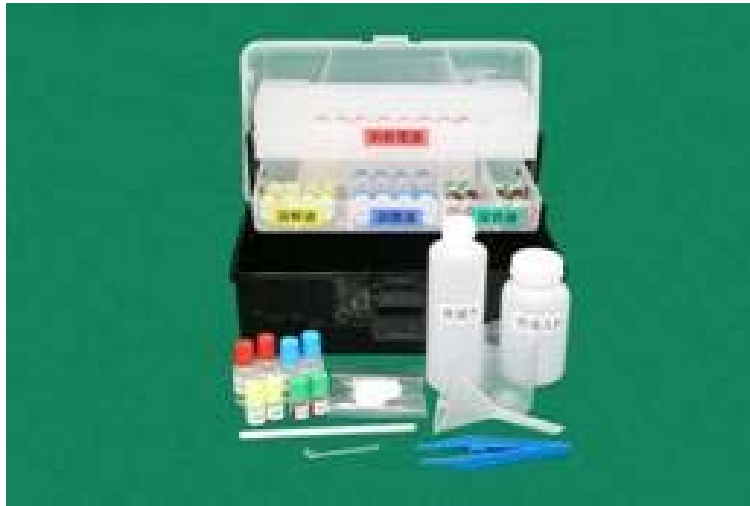
図6 アスベストワカールプロ簡易測定キット
