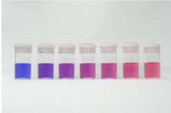
マグネシウムによる呈色 (クリソタイル含有試料50mg中のMg量 左から順に: 0, 2, 5, 10, 20, 50, 100 \mu g)
