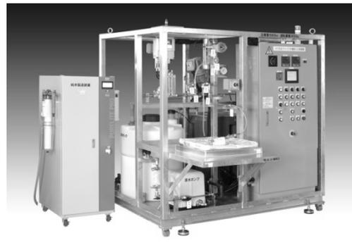
写真 3 ヨウ素水製造・充填装置
