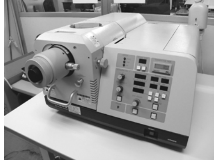
図 2 イオンミリング装置 (日立ハイテクノロジー製 IM4000)
